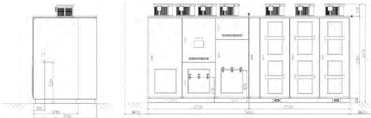
Габаритные размеры по фундаменту, крепление преобразователя частоты, прокладка кабелей
