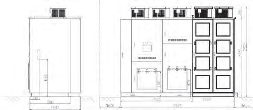
Габаритные размеры по фундаменту, крепление преобразователя частоты, прокладка кабелей
