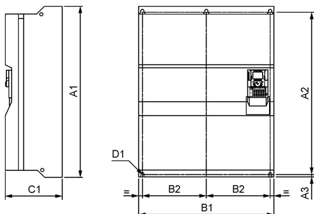
При установке устройств вплотную друг к другу требуется минимальное расстояние для достаточного охлаждения (значения в скобках).
