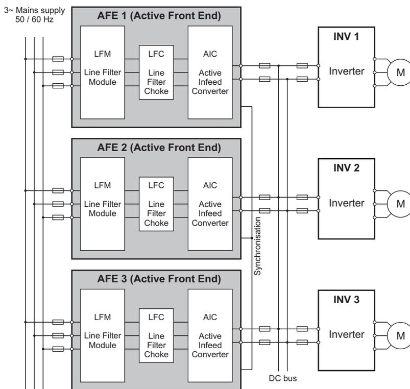
Параллельное подключение активных выпрямителей напряжения возможно без уменьшения мощности. Управляться при параллельном подключении могут АВН различной мощности, но при этом мощность наименьшего АВН не должна быть меньше 50 % мощности наибольшего устройства.
