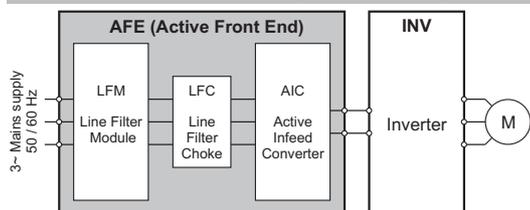
Активный выпрямитель напряжения, устанавливаемый на входе ПЧ, состоит из трех компонентов:
