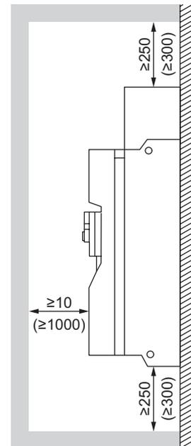
При установке устройств вплотную друг к другу требуется минимальное расстояние для достаточного охлаждения (значения в скобках).
