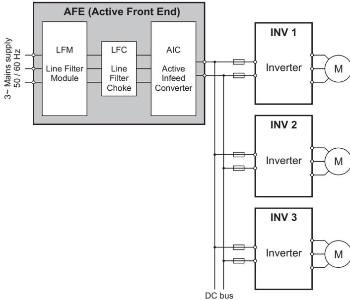
Суммарная мощность установленных ПЧ может быть больше номинальной мощности активного выпрямителя напряжения. При выборе полной конфигурации важной характеристикой, которая должна быть учтена, является максимальная нагрузочная способность сетевого фильтра.
