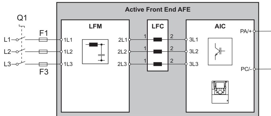
АВН мощностью свыше 430 кВт (свыше 540 кВт при питании 500/690 В) содержит активный выпрямитель напряжения, **два** модуля сетевого фильтра и **два** сетевых дросселя, каждый из которых состоит из трех однофазных дросселей.
