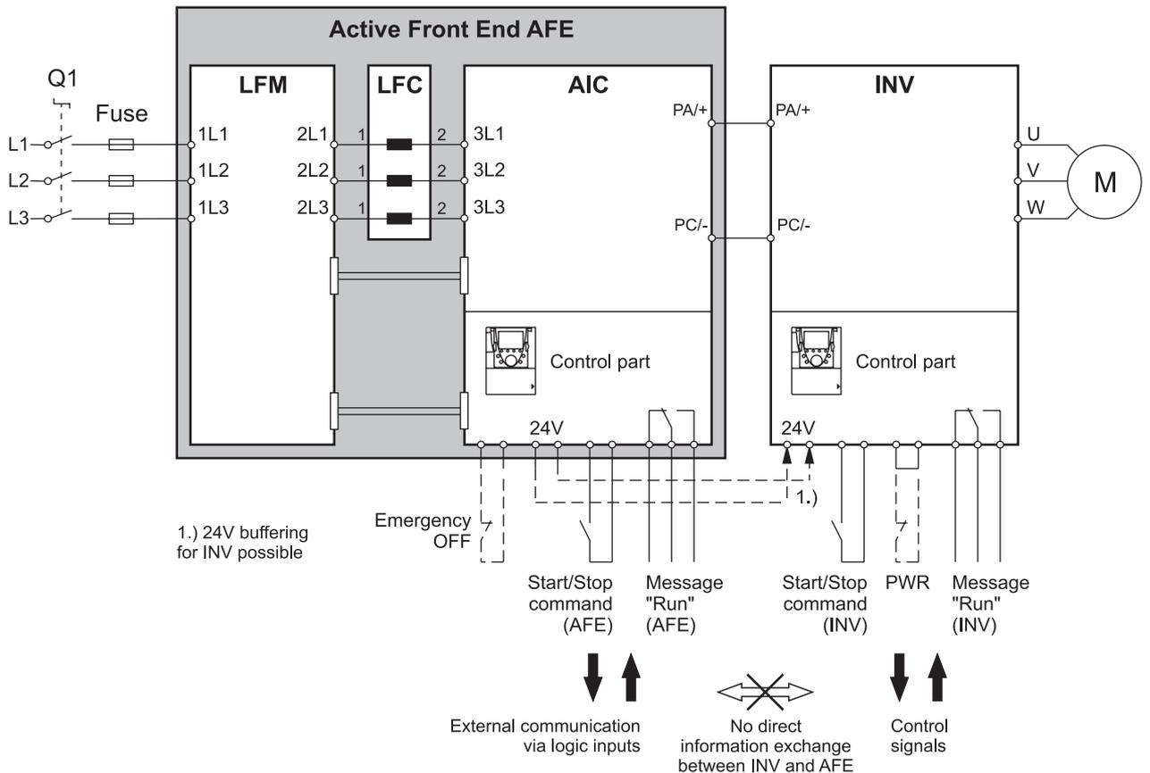
Управление с помощью сигналов пуска/остановки ПЧ
