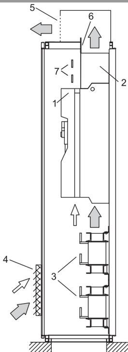
Расчетные потери и минимальное сечение секций воздухозаборника зависят от автономного инвертора напряжения. Кроме того, должны учитываться удаленные источники тепла, например, такие как предохранители и контакторы. Вентилятор силовой части, находящийся внутри устройства, обеспечивает воздухообмен в шкафу. Воздушный поток не должен ограничиваться другим оборудованием и фильтрами. Необходимо разделить поток силовой части, чтобы избежать появления внутренних участков перегрева.
