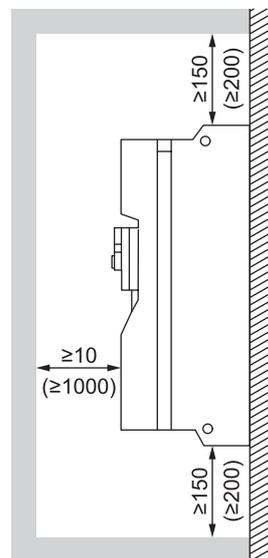
При установке устройств вплотную друг к другу требуется минимальное расстояние для достаточного охлаждения (значения в скобках).
