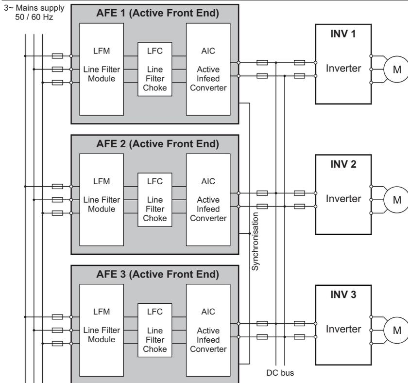
Для специальных проектов существует также возможность параллельного подключения нескольких активных выпрямителей напряжения (конфигурация n:n).
