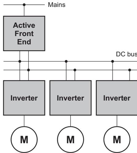
Идеальным решением для многодвигательного привода является питание от общего ЗПТ (например, листопрокатные станы, рольганги или испытательные стенды). В этом случае суммарная мощность ПЧ может быть в 4 раза выше мощности АВН
