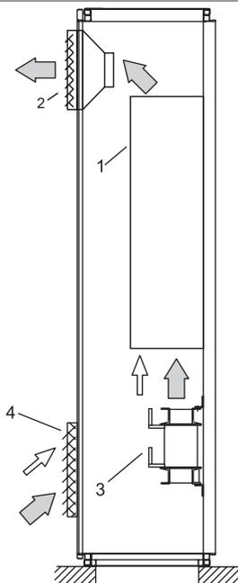
Поскольку модуль сетевого фильтра не имеет внутреннего вентилятора, то необходимо установить вентилятор на дверце шкафа для воздухообмена. Это предотвращает перегрев и обеспечивает охлаждение сетевого дросселя LFC. Воздушный поток не должен ограничиваться другим оборудованием и фильтрами.
