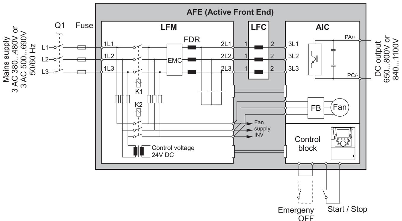
Уже на стадии разработки отдельных элементов активного выпрямителя напряжения были приняты в расчет простота установки и ввода в эксплуатацию. Так, модуль сетевого фильтра LFM содержит не только реальные элементы фильтра, но и компоненты зарядной цепи, сетевой контактор, источник питания всех вентиляторов устройства и требуемые для питания цепей управления источники. Для подключения цепей управления между отдельными компонентами предусмотрены смонтированные кабели и надежные разъемы.
