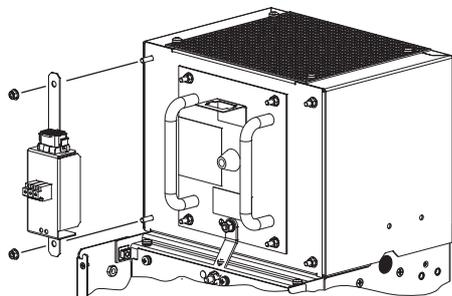
Вентиляторный соединитель 6 В обеспечивает простое подключение вентиляторов в преобразователях частоты (при питании 690В).
