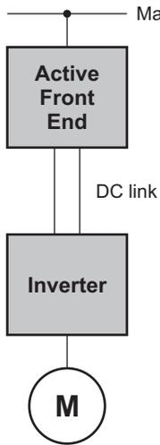
Стандартный частотно-регулируемый привод в совокупности с АВН возвращает в сеть вырабатываемую энергию (например, при спуске груза)
