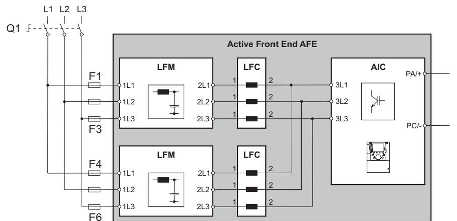
В случае однодвигательного привода активный выпрямитель напряжения подключается прямо к клеммам звена постоянного тока стандартного ПЧ.
