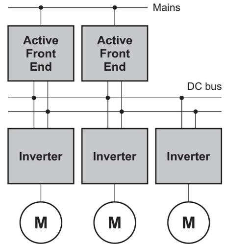
Параллельное подключение до четырех АВН применяется с одной стороны для увеличения безопасности за счет дублирования, а с другой – для увеличения мощности установки или уменьшения мощности используемых АВН
