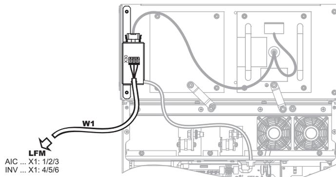
Для питания вентиляторов в ПЧ ATV71HC40Y - HC63Y и ATV61HC50Y- HC80Y соответственно необходимо заказать два вентиляторных соединителя 6 В (VW3 A7 280).
