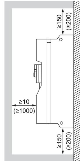
При установке устройств вплотную друг к другу требуется минимальное расстояние для достаточного охлаждения (значения в скобках).
