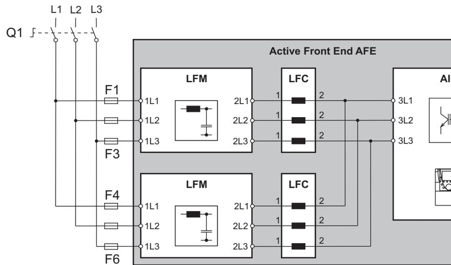
В случае общего звена постоянного тока все ПЧ подключены к выходу ЗПТ активного выпрямителя напряжения.
