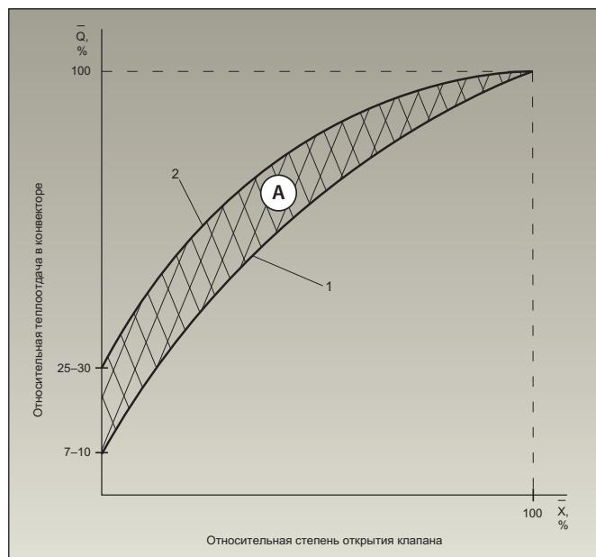
**Рис. 13.** Эффективность регулирования конвектора.
