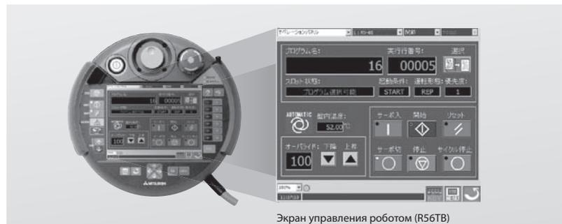
Обеспечивает автоматическое управление включением/отключением серводвигателя, запуск и останов, сброс, выбор программы и другие операции.
